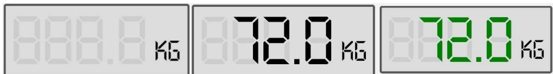
دستگاه وارد مرحله وزن‌گیری می‌گردد که با قرارگرفتن فرد بر روی دستگاه پس انجام عمل وزن‌گیری، با ثابت قرارگرفتن فرد بر روی دستگاه عدد داخل کادر به رنگ سبز در می‌آید که نشان‌دهنده انجام
